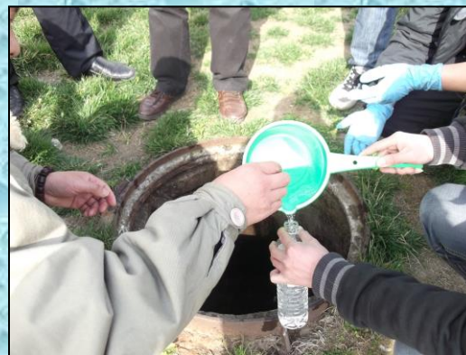
园区环境监察大队到厂废水采样
